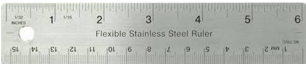
شكل (١ - ٣): مسطرة قياس الأطوال وتظهر وحدات الإنش والسنتيمتر
